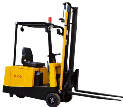
FL – 10 Mini Fork Lift Capacity 1000 Kgs Lift Height 3100 mm
